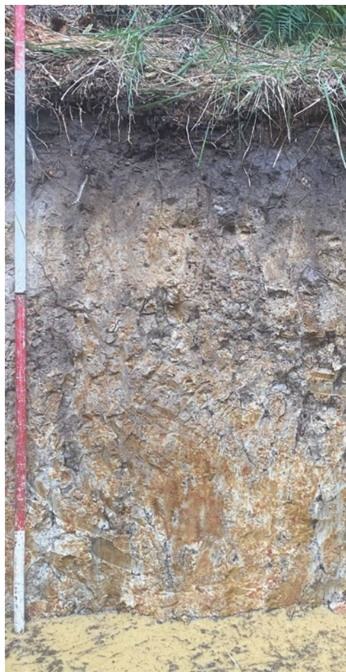
Profil de sol avec nappe d'eau temporaire
