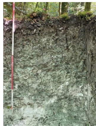
Sol hydromorphe très argileux sur calcaire (pélosol)
